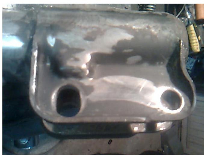
Après limage, le trou correspond à celui du renfort.
