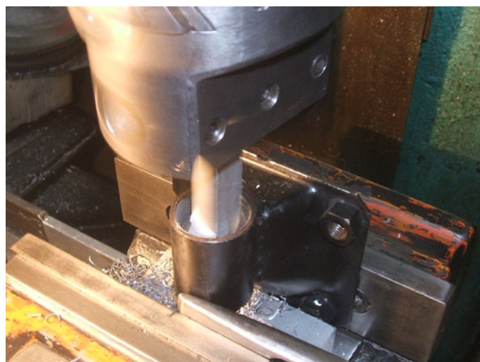
Alesage à la côte extérieure du roulement.
